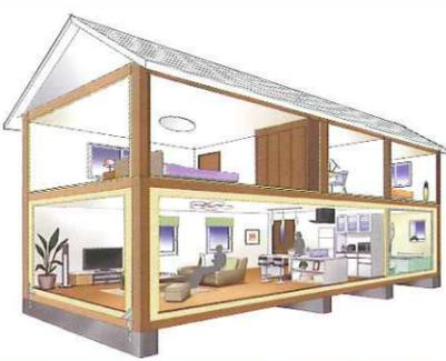
吹付発砲硬質ウレタンフォームで隙間なく断熱。
